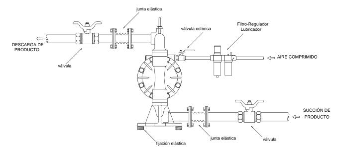
Para obtener mejores resultados y preservar el equipo, es conveniente colocar en la línea de aire y lo más cerca posible de la bomba una unidad filtrante, reguladora de presión y lubricadora (FRL).
